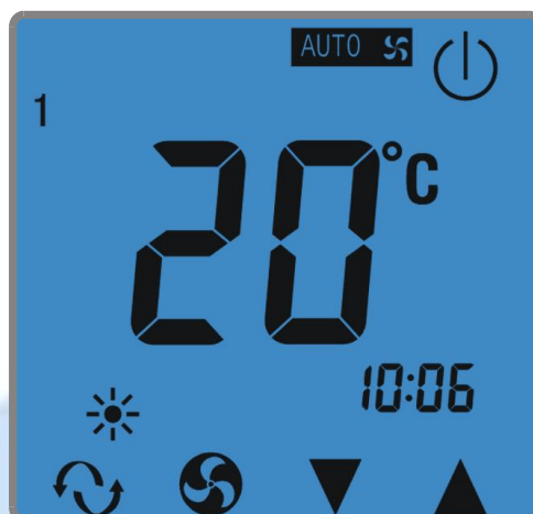
Ekran 5. Aktywacja nagrzewnicy kanałowej
